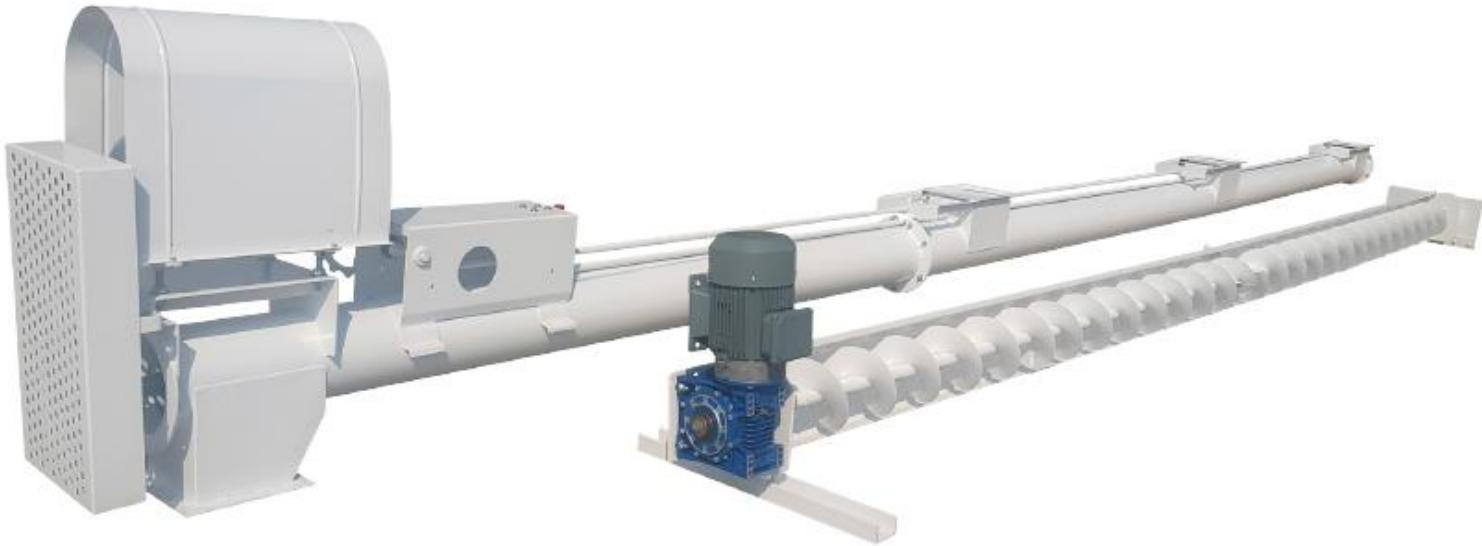
Silo alt boşaltım helezonu silonun içindeki hububatın silo dışına taşınmasına yardımcı olur. Helezon sisteminin üzerinde bulunan kapaklar ve bu kapakları kumanda eden mekanizma sayesinde silonun güvenli bir şekilde boşaltımı gerçekleştirilir. Kumanda merkezi ilk olarak merkezdeki kapağı açarken diğer kapakların açılmasına olanak vermez. Merkez kapaktan akış bittiğten sonra diğer ara kapaklar açılır.
